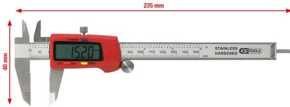
Calibre Digital con Rueda de Fijación
